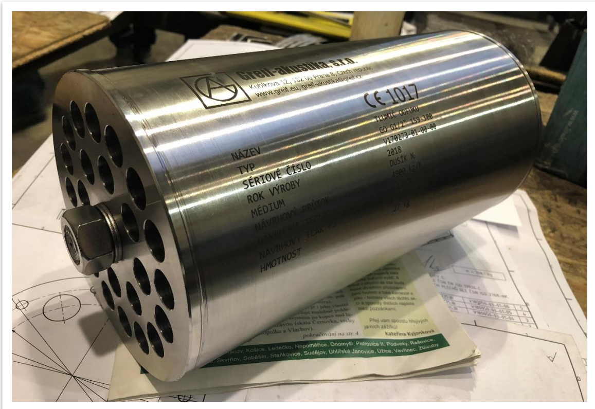
Tlumič hluku odfuku dusíku, PS = 400 bar(g).
